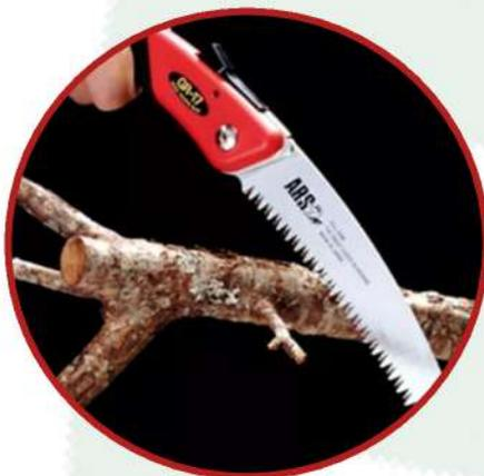
**Curvatura en los serruchos de poda:** Algunos modelos tienen hojas curvas que permiten cortes más rápidos y eficientes en ramas al mantener más dientes en contacto con la superficie durante el corte.
